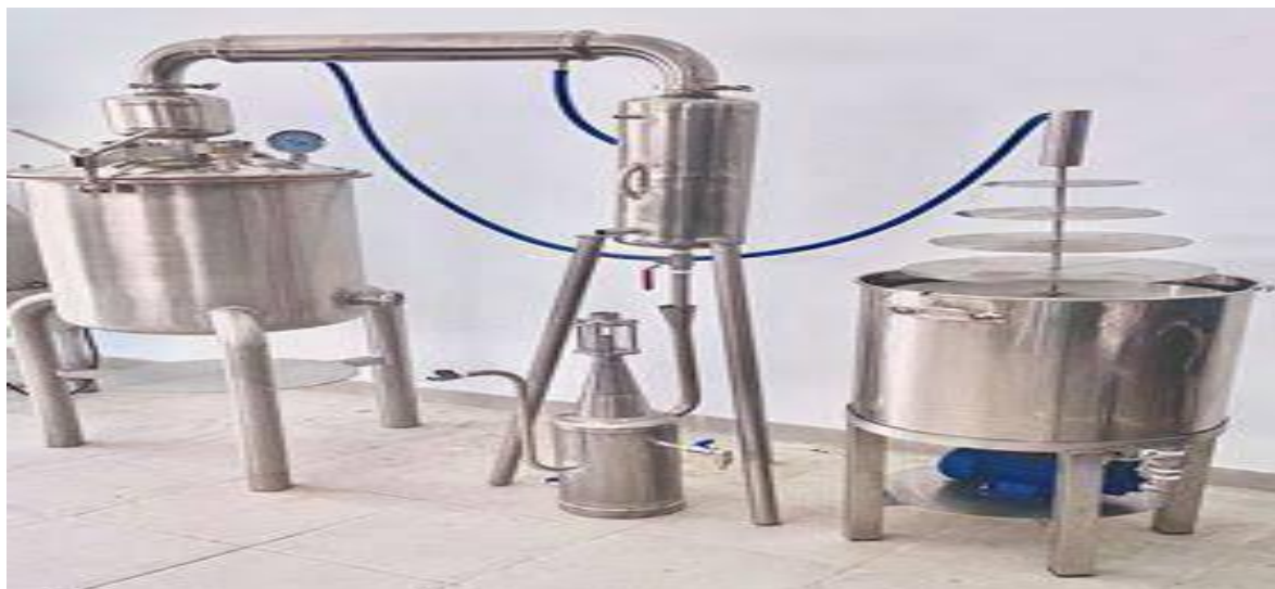
Figure10: Appareil d'hydro distillation de type Clevenger.
