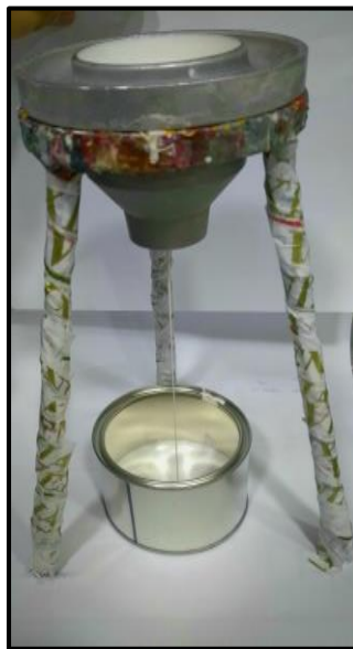
Figure II.5 : Mesure de temps d'écoulement
