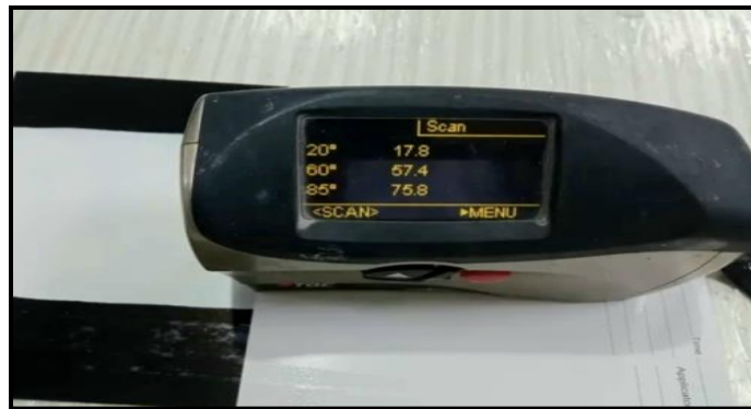
Figure II.7 : Mesure de la brillance
