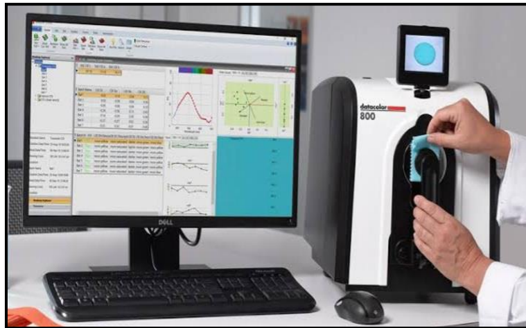
Figure II.9 : Analyse colorimétrique avec le spectrophotomètre
