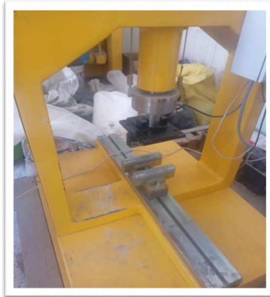
Figure.IV.15 La faculté dispose d'une machine d'essais de flexion et de compression pilotée par ordinateur. Cette machine est utilisée pour effectuer des essais de flexion sur des éprouvettes, puis les mêmes échantillons sont utilisés pour les essais de compression.
