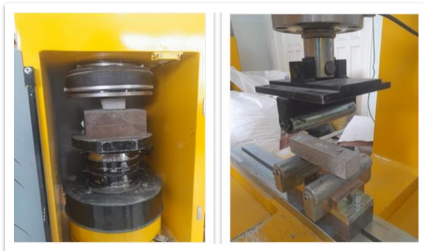
Figure. IV.16 Essais de flexion et compression
