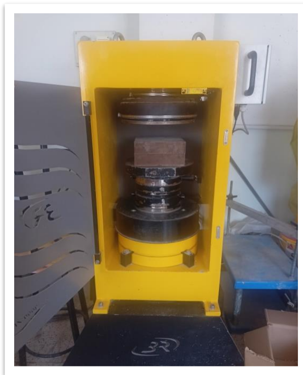
Figure.IV.14 Une machine de compression automatisée contrôlée par ordinateur pour les essais. (Laboratoire de la faculté).
