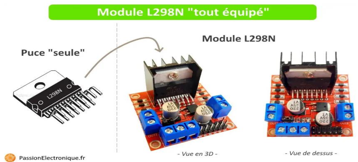
Fig.II. 11. Module L298N (tout équipé)
