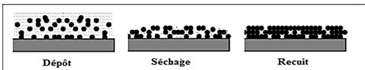
Figure II-9 : Influence du séchage et traitement thermique sur la porosité des couches minces.
