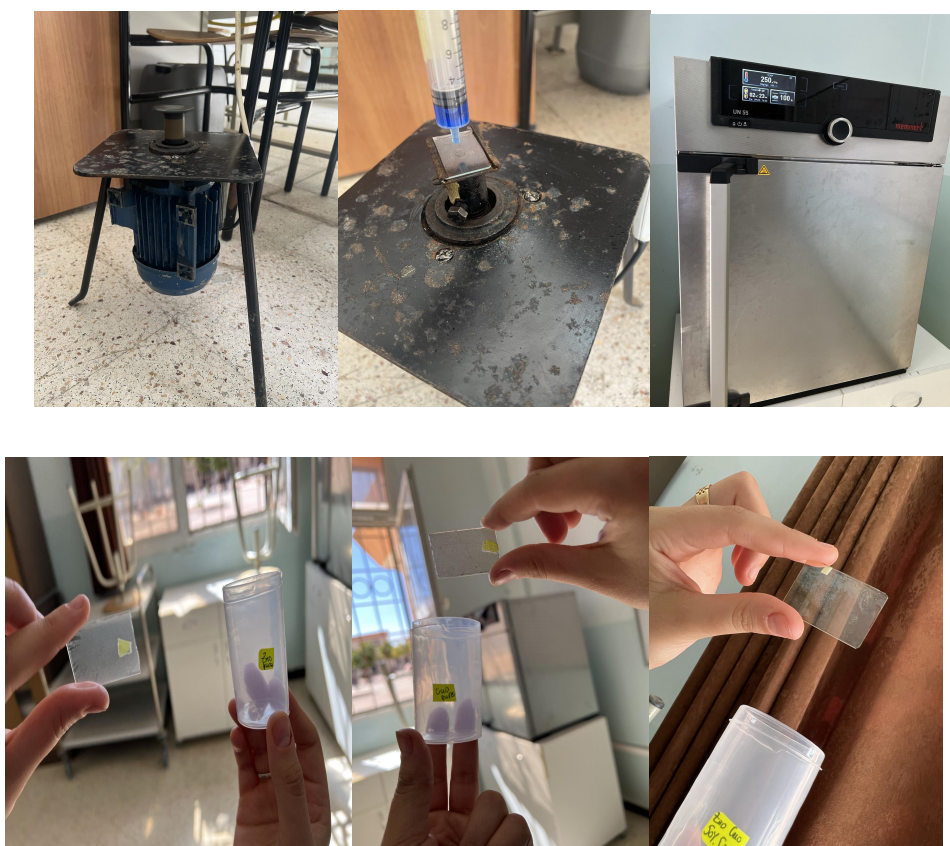
Figure II-14 : Dépôt de multicouches minces ZnO.CuO et ZnO :CuO par la technique spin-coating.
