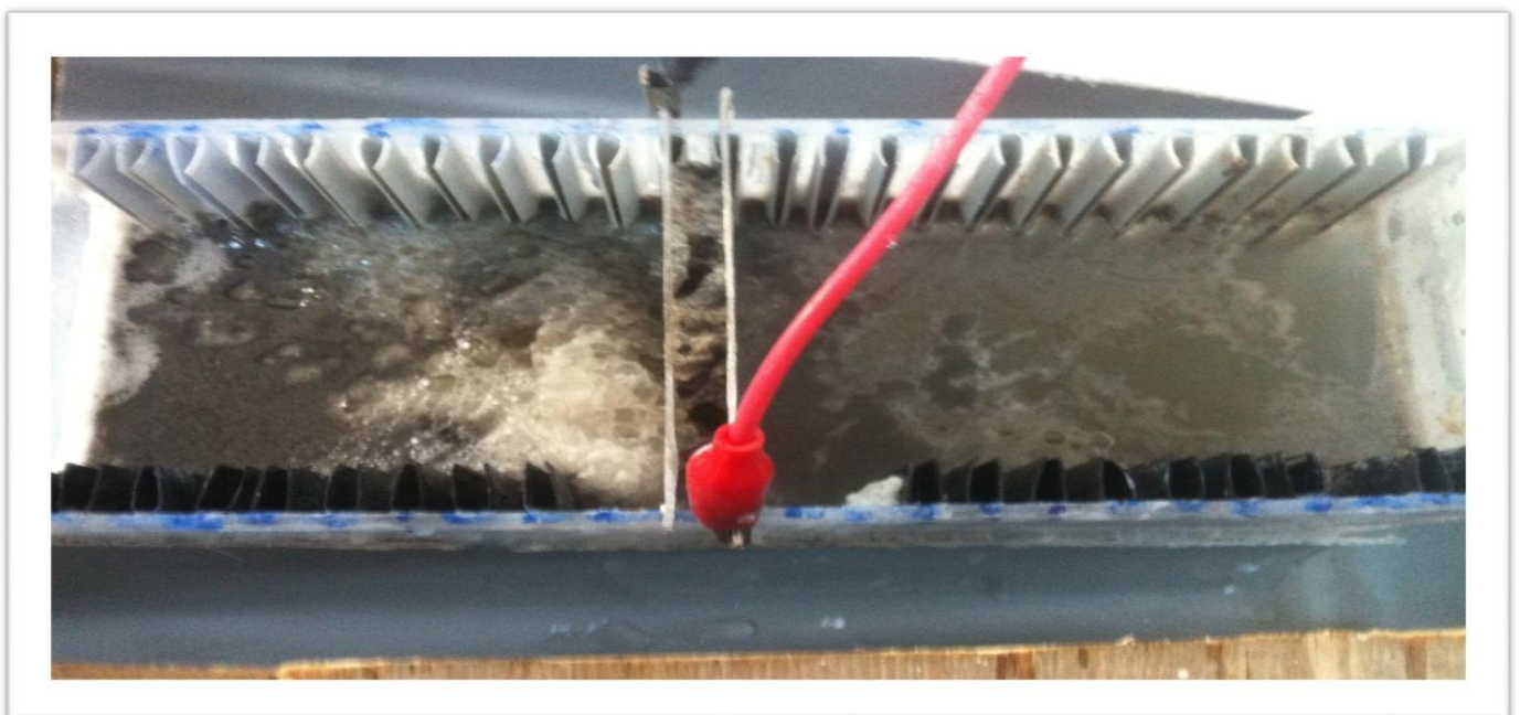
Figure IV.5 : vue du haut du dispositif expérimental du procédé électrochimique en plein fonctionnement
