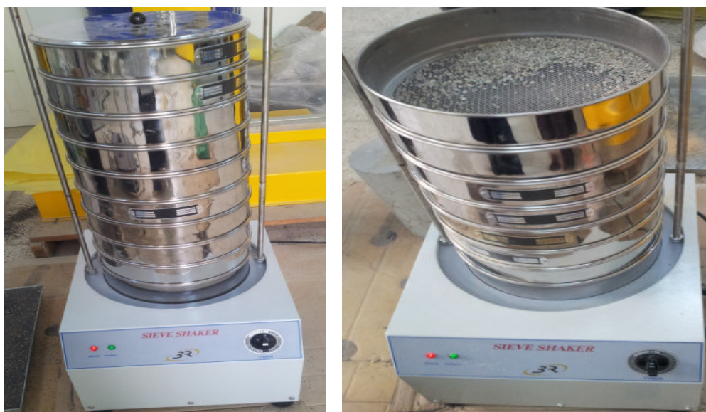
Figure 1 : L'essai d'analyse granulométrique.
