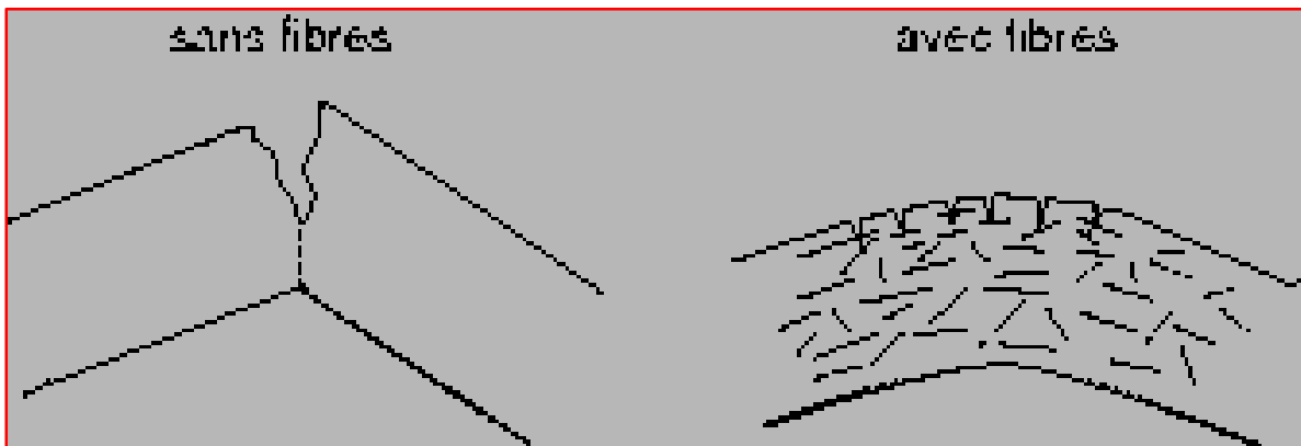
Figure IV.2: Fissuration dans le béton sans et avec fibres[17]
