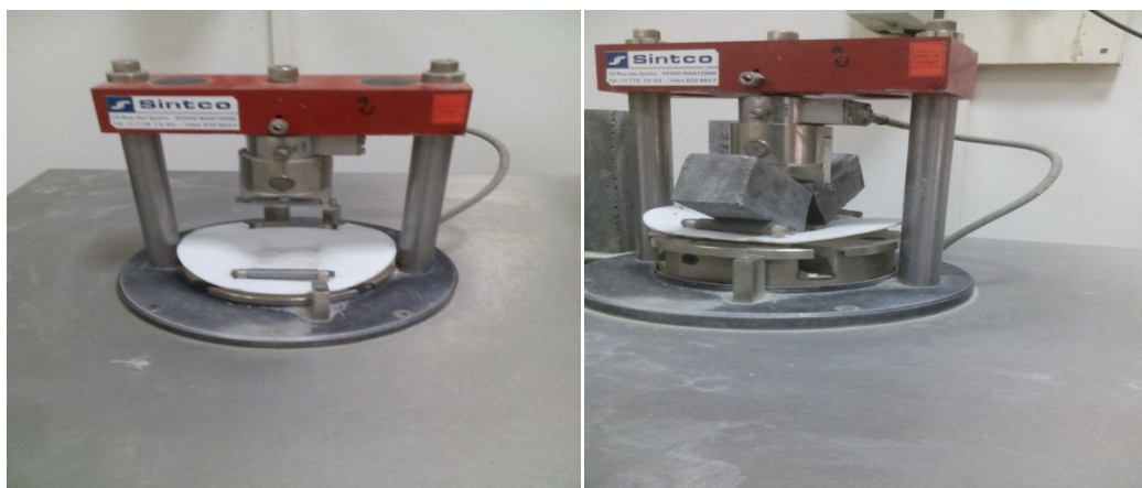
Figure 18. Essai de traction par flexion.
