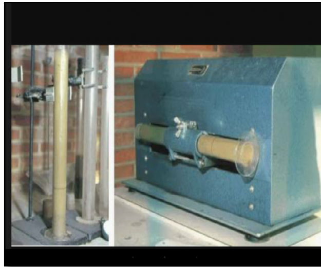
Figure 2: L'essai d'équivalent de sable
