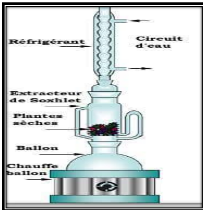
Figure 2 : Représentation d'un extracteur de soxhlet (BLANCHART et LAUVERGNE, 2017)
