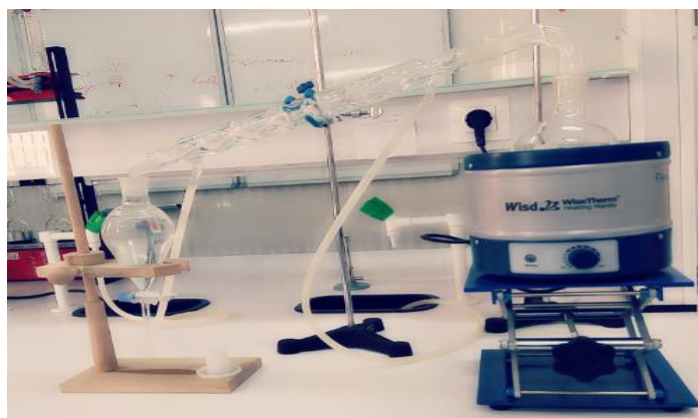
Figure 13 : Extraction par hydro-distillation des HE du Marrube blanc ( original )
