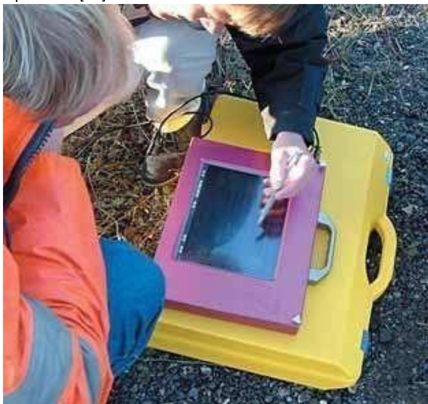
FIGURE 3.5 – Matériel d'auscultation par réflexion et impédance : Enregistrements graphiques sur micro-ordinateur.
