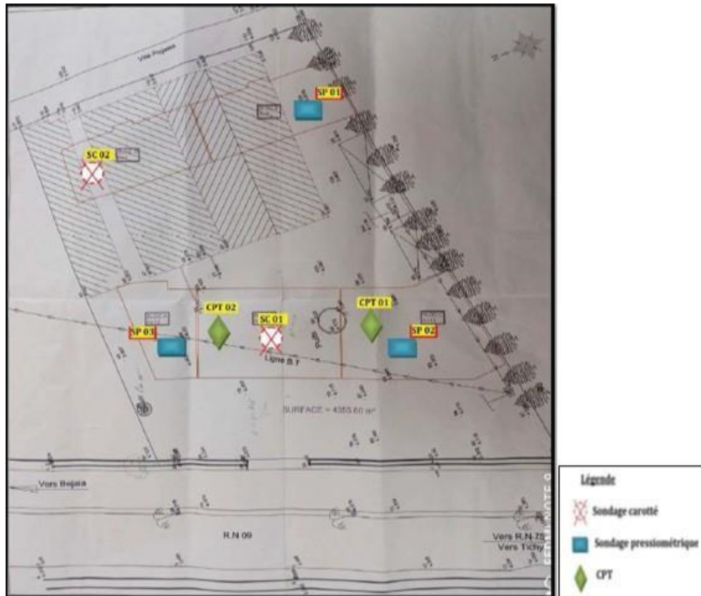
FIGURE 5.5 – Implantation des essais sur le terrain du projet.
