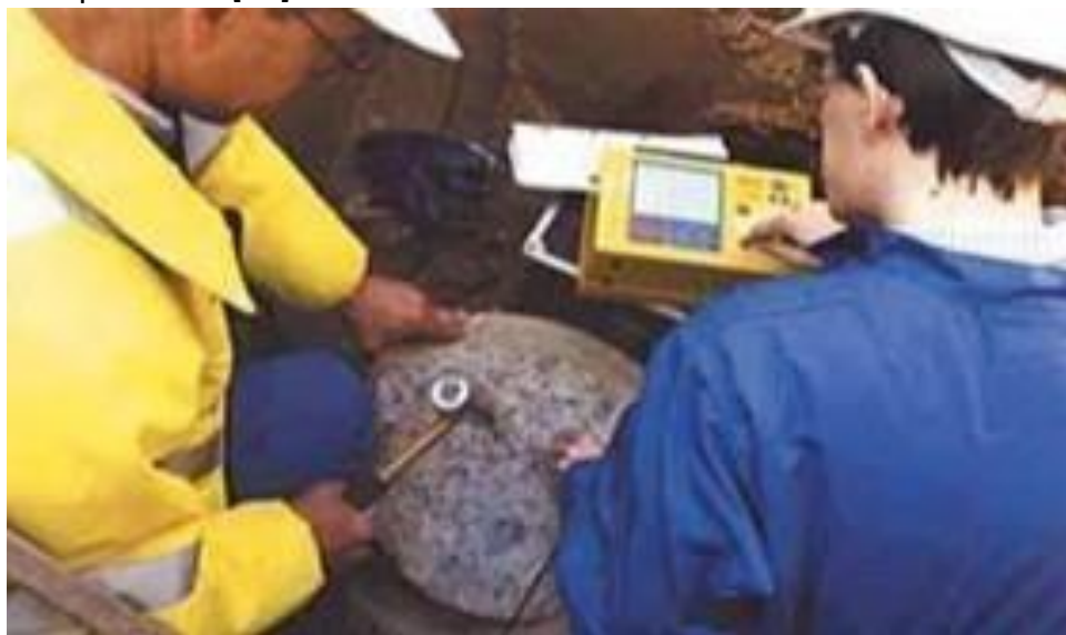
FIGURE 3.18 – Matériel d'auscultation par réflexion et par impédance. Matériel de première génération.
