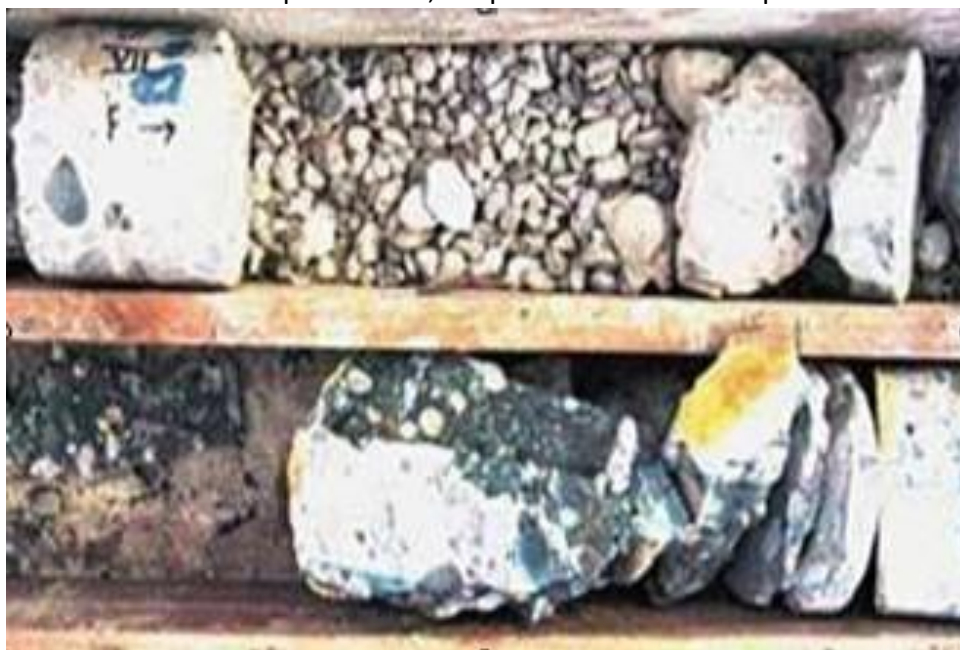
FIGURE 3.13 – Carotte extraite d'un fond de pieu.
