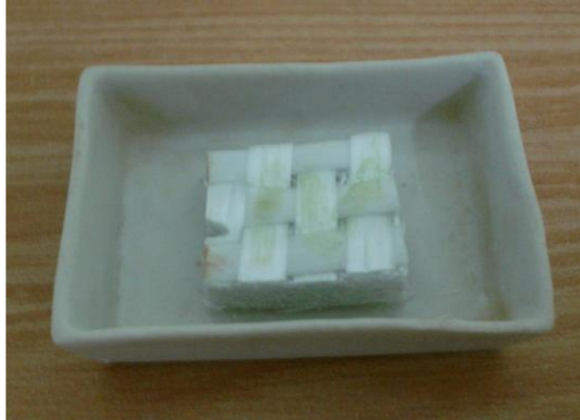
Fig.4.5 : Matériau composite après essai de calcination.
