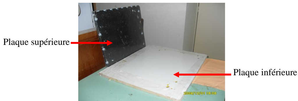
Fig.4.1: Le moule utilisé pour la fabrication des éprouvettes.
