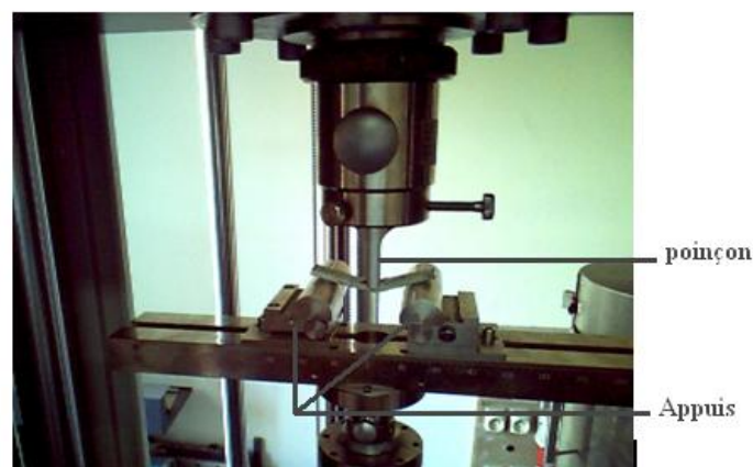
Fig.4.27 : Dispositif pour l'essai de flexion.
