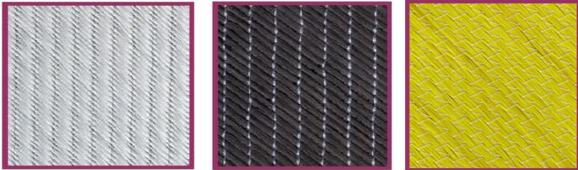
Figure I.7. De gauche à droite -fibre de verre, de carbone et d'aramide [5].
