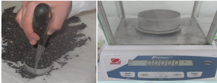
Figure IV. 9 : Essai de masse volumique des granulats.
