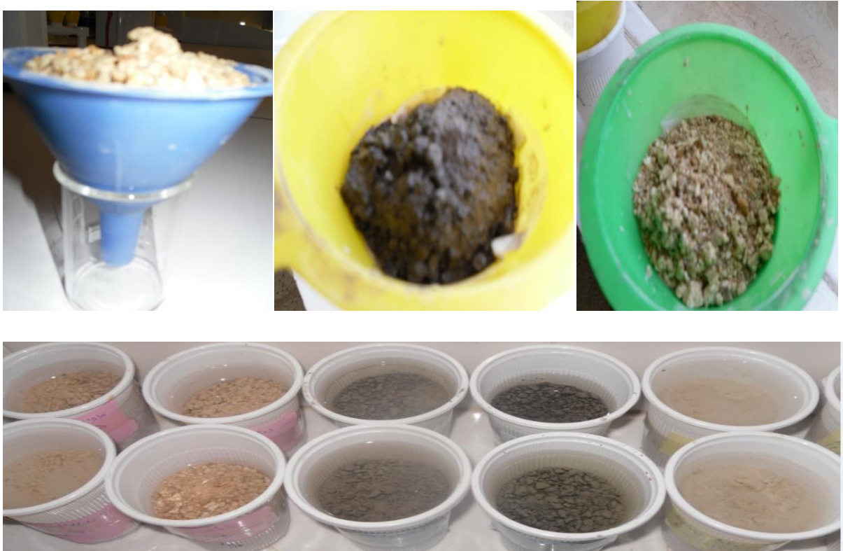
Figure IV. 10 : Essais d'absorption des granulats (l'alumine, MG, Silico Al).
