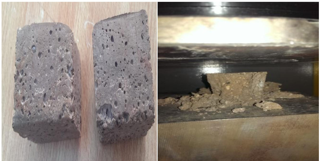
Figure IV. 20 : les deux éprouvette 4*4*4 après cuisson à 600°C et l'ors de caractérisation
